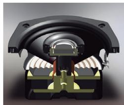
ツイーターはシルク素材に特殊コーティングしたソフトドーム・タイプのユニットをベースに、特殊ウレタンでカウリングすることで不要な振動を防ぎ、高域の純度をさらに高めています。ウーハーにはコシのある低域を生み出す特殊樹脂コーティングを施したパルプコーンを採用し、フルボディで懐の深い音を再生します。ネットワーク部のコンデンサーには音質重視のフィルムコンデンサーを採用。さらに、空芯コイルを用いて磁気歪みも追放しています。
