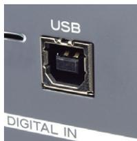
入力可能なファイル形式は、最大24bit/192kHzのPCMに対応。一般のオーディオCDの音質をはるかに超える高解像度のオーディオデータをフルに活かすために、ジッターノイズを抑えて正確なクロック信号を元に転送を行うアシンクロナスモード(非同期モード)にも対応するなど、音質劣化を引き起こす要素を排除した仕様です。
