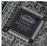
さらに、データ転送はUD-H01の高精度内蔵クロックによってタイミング制御を行うアシンクロナス・モード (非同期モード) に対応しているため、パソコン側のクロック精度に起因するジッターを排除したピュアな状態でデジタルオーディオ処理が可能。音質を最優先した設計です。
