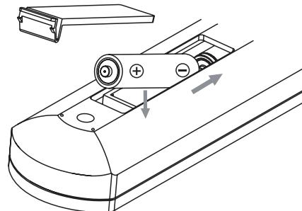
**1** Öffnen Sie die Batteriefachabdeckung der Fernbedienung.
