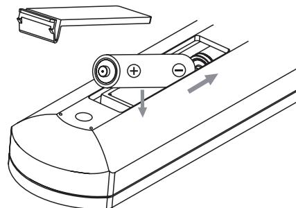
**1** Open het deksel van de afstandsbediening.
