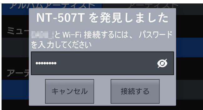
接続が完了すれば、本機の Wi-Fi インジケーターが点灯に変わります。
